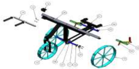
Gambar 3. Bagian - Bagian Rice Transplanter
