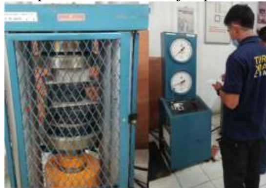
Gambar 6. Pengujian Kuat Tekan Paving Block
