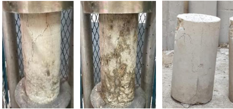
Gambar 7 Dokumentasi hasil pengujian kuat tekan beton tambahan serat rotan 2%
