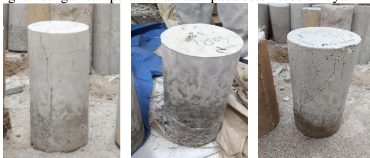
Gambar 8 Dokumentasi hasil pengujian kuat tekan beton tambahan serat rotan 3%
