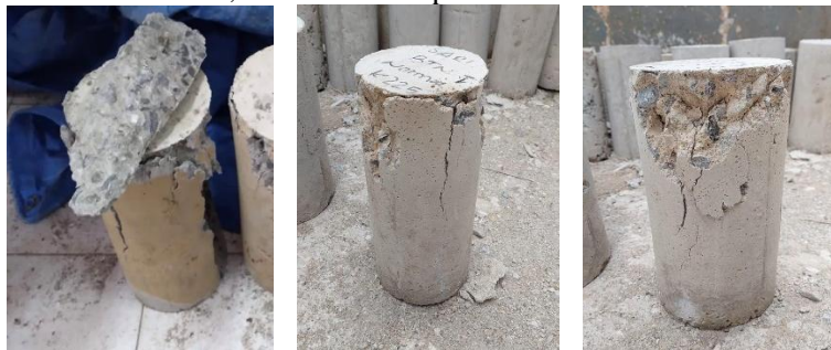
Gambar 5 Dokumentasi hasil pengujian kuat tekan beton normal
