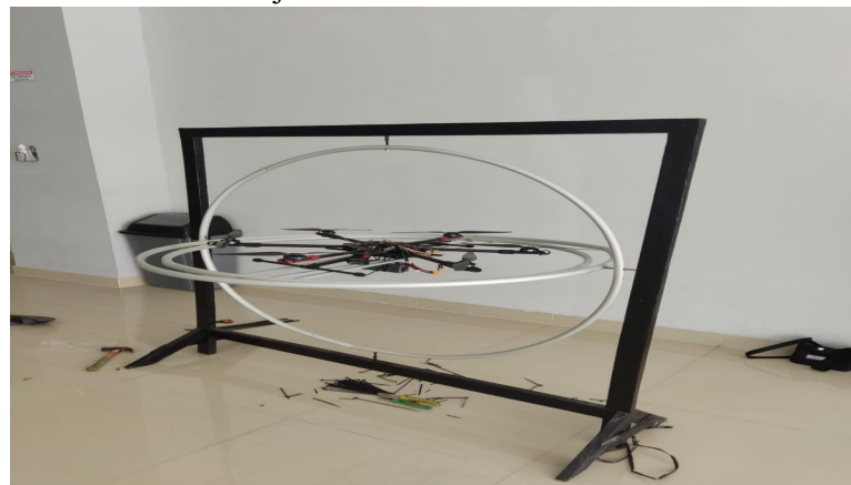
Gambar 1 Hexacopter Pada Stand Uji
