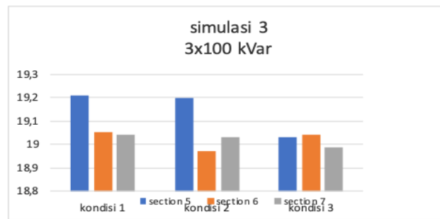
Gambar 5 Grafik krakteristik tegangan tegangan pada simulasi 3 pada kondisi 1, 2, 3 sesudah pemasangan kapasitor bank 3x100 kVar pada simulasi ETAP 19.0.1
