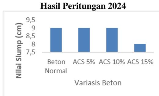
**Gambar 1. Diagram Hasil Uji Slump**
