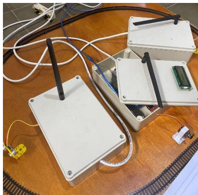
Gambar 4. Prototipe Sistem Pengaman Perlindungan Kereta Api Berbasis Teknologi Sensor dan Komunikasi Nirkabel
