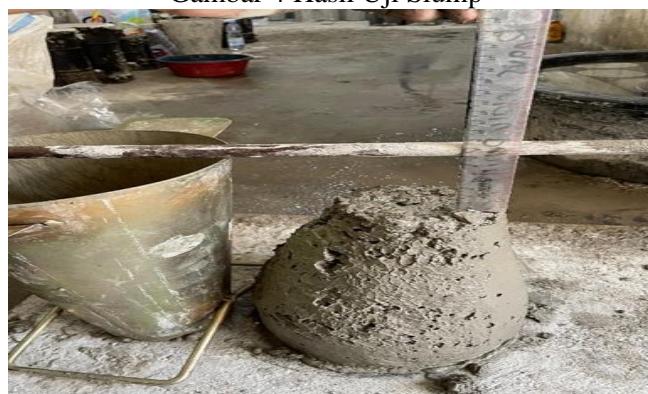
Gambar 4 Hasil Uji Slump
