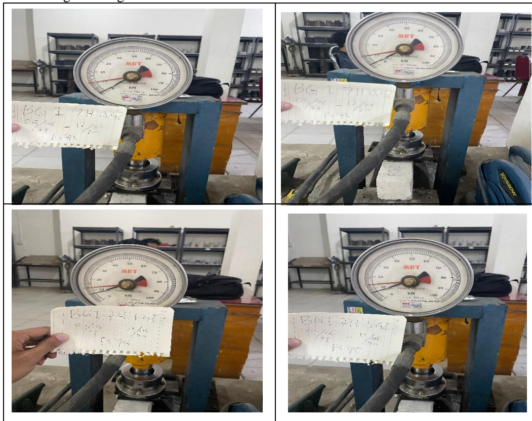
Gambar 6 Hasil Pengujian Kuat Lentur
