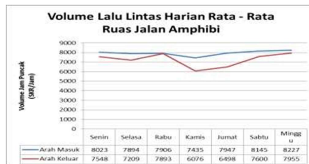
Gambar 8 Grafik Volume Lalu lintas Harian Rata - Rata Ruas Jalan Amphibi di Arah Masuk dan Arah Keluar Sumber: Hasil Analisis Data, 2024
