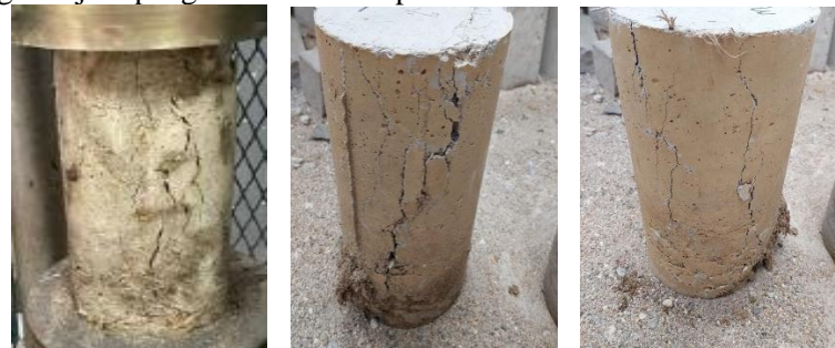
Gambar 6 Dokumentasi hasil pengujian kuat tekan beton tambahan serat rotan 1%
