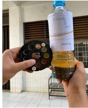
Gambar 2 Pemeriksaan zat organik agregat halus
