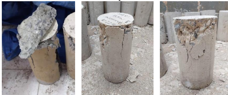
Gambar 5 Dokumentasi hasil pengujian kuat tekan beton normal
