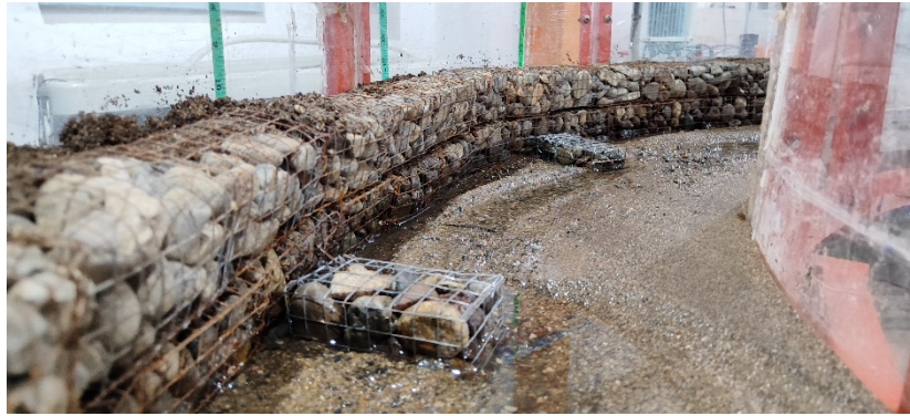
Gambar 10. Terjadi sedimentasi di hilir sirip hilir (dilihat dari hilir)
