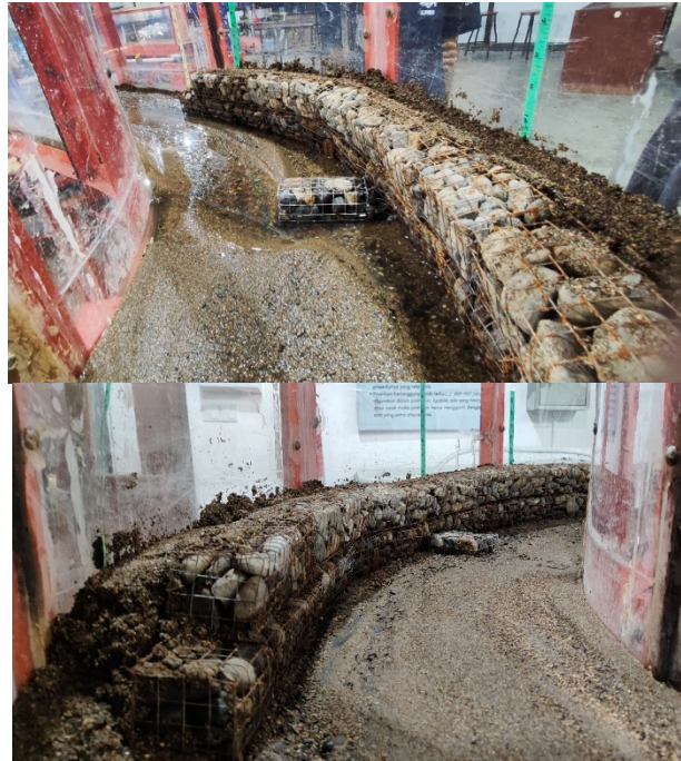
Gambar 7. Bronjong dan sirip turun di bagian hilir tikungan (dilihat dari hulu dan hilir)
