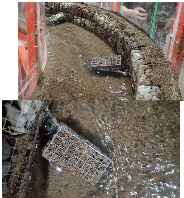
Gambar 17. Terjadi sedimentasi di hilir sirip hilir (dilihat dari hulu dan hilir)
