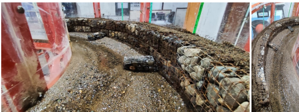
Gambar 14. Topografi yang terbentuk pada setup 4 (dilihat dari hulu dan hilir)
