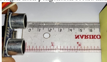
Gambar 5. Perbandingan Pengukuran Jarak Benda Oleh Sensor dan Manual
