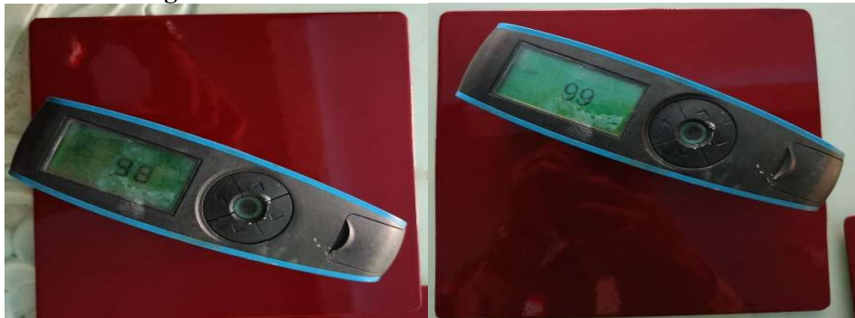
Gambar 4. Hasil Pengukuran Gloss Meter pada Sampel Pengecatan Tanpa Water trap (Sumber: Dokumentasi Penelitian)
