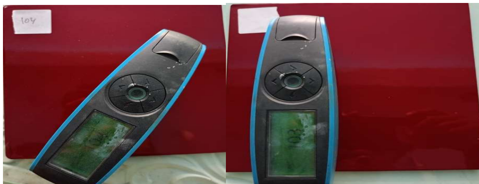
Gambar 5. Hasil Pengukuran Gloss meter pada Sampel Pengecatan Menggunakan Water trap (Sumber: Dokumentasi Penelitian)
