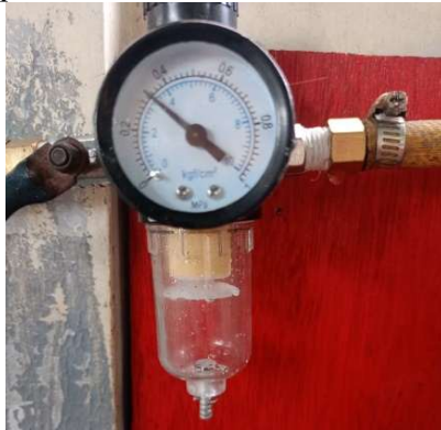
Gambar 1. Kandungan Air pada Filter Kompresor (Sumber: Dokumentasi Penelitian)
